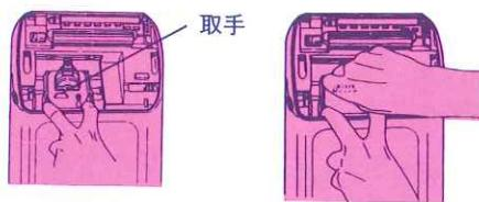
左図のようにリボン抑えを手前に引いたまま、カセットの取手をもって引き抜くように取り出します。
