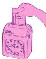
印字欄を確認してカードを軽く挿入します。
