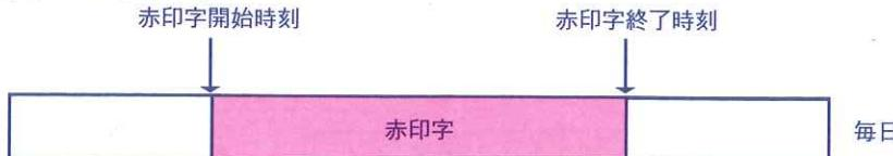
赤印字開始時刻のみの設定の場合（赤印字終了時刻が設定されていない場合）は印字段切換時刻までが赤印字となります。
