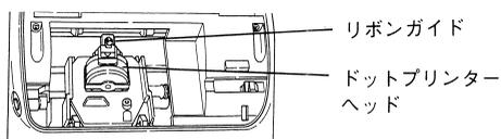
リボンカセットを、リボンガイドとドットプリンターヘッドの間に正しく入れます。
