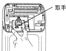
上図のようにリボン押えを手前に引いたまま、カセットの取手をもって引き抜くように取り出します。
