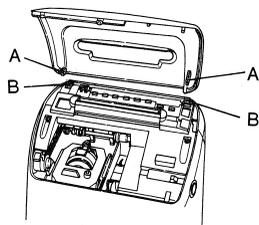
上ぶたのフック（上図A）を本体フック（上図B）に引っ掛けて、上ぶたを手前に倒してはめ込みます。
