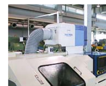
工作機械に搭載された オイルミストコレクター
