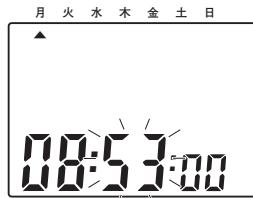
→時刻の設定が完了し、現在時刻が表示されます。SET UP画面のトップ画面に戻るには、再度 [E] ボタンを押します。
