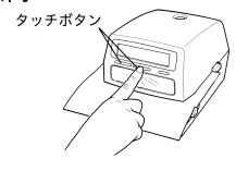
用紙を差し込み、印字位置を確認 後、指でタッチボタンを押すと印 字します。
