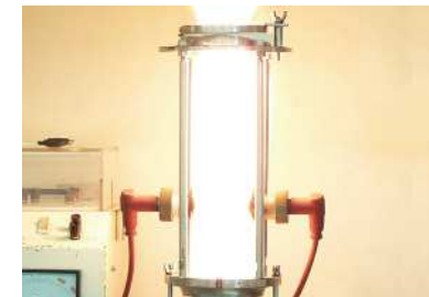
③粉じん爆発下限濃度測定装置 Blow-up type dust explosion test device 爆発下限の濃度を求めます。 Used for determining the explosion lower limit temperature.
