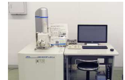
②分析走査電子顕微鏡 Analytical Scanning Electron Microscope フィルター表面等の観察に使用します。 Used for observing filter surfaces, etc.
