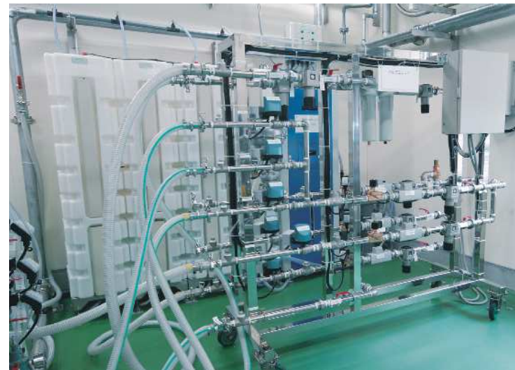
②サニタリーライン(2) Granular/Powder conveyance test line for sanitary use (2)
