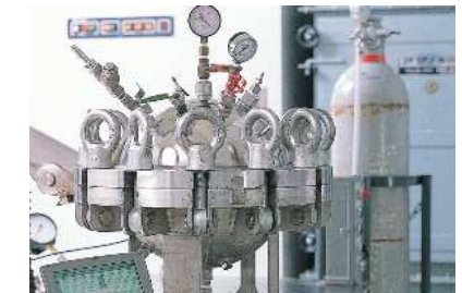
④30リットル球形粉じん爆発試験装置 30liter spherical explosive particle test device 爆発圧力、Kst値の測定をします。放射面積を求めるためのデータ採取を行います。 Measures the explosion pressure and Kst values. Collects data to determine radiation area.
