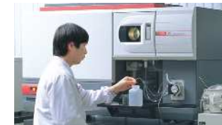
⑤誘導結合プラズマ発光分光分析装置 Inductively coupled plasma emission spectrometry analyzer 水溶液試料中の元素同時定量分析を行います。 Used for simultaneous quantitative analysis of elements in the sample solution.
