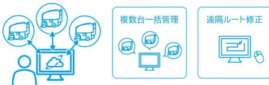
クラウド上で修正したルートをロボットに自動走行させることが可能
