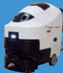
自律走行式 ロボット床面洗浄機「EGrobo」
