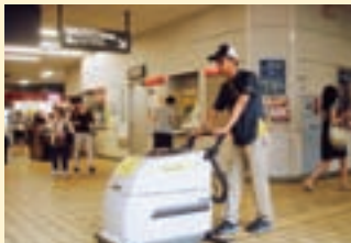
自動床面洗浄機による 駅コンコースの洗浄作業
