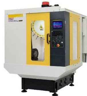
FANUC ロボドリルの操作盤で状態に合わせてミストコレクターを制御
